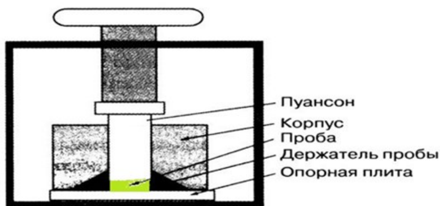
Рис. 2.2. Пресс-форма для прессования образца с \text{KBr} .
